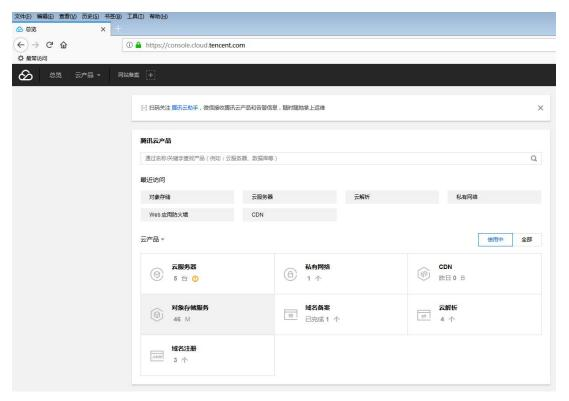
2、选择 存储桶列表 再点击一下 创建存储桶 ,输入一个 名称 ,然后选择一下 所属 地域 (建议和前面所选云服务器在同一个区域),然后点击 确定
