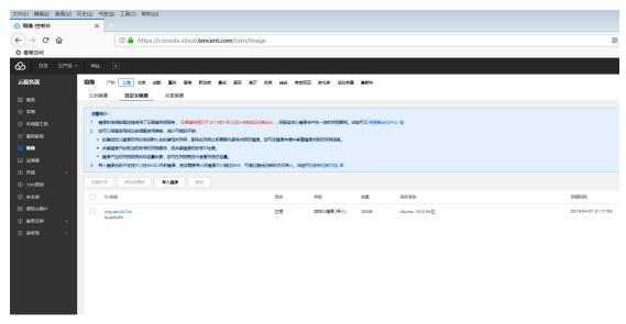
9、再点击 实例 ,到前面创建的 云服务器,再选择 重装系统 ,然后再选择 自定义镜像 ,接着在 镜像 选项卡里 选择前面导入 镜像文件 ,再点一下 开始重装 ,至此已经全部安装完成了
